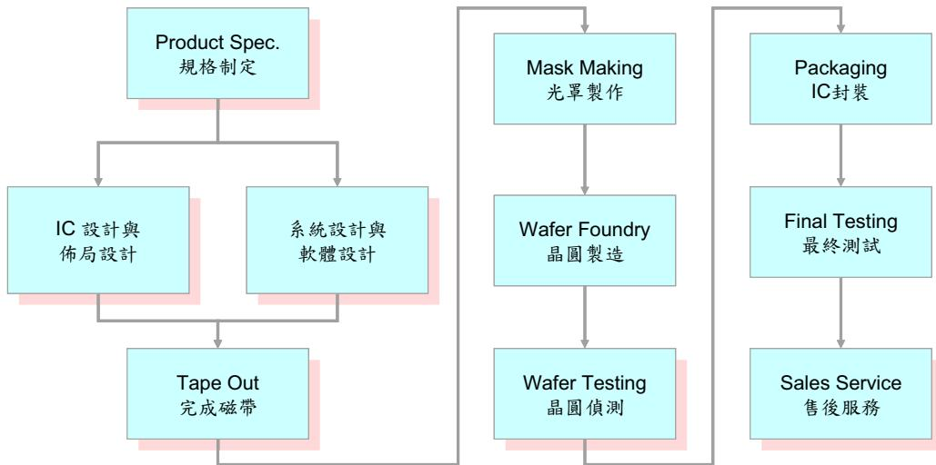
在上述晶粒產製過程中，本公司負責規格制定、IC 設計及系統設計、晶圓針測及售後服務等業務。光罩製作、晶圓製造、晶圓切割、IC 封裝及最終測試等則委託專業廠商代工。
